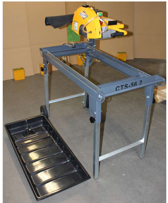
Wasserwanne entnommen und neben der Tischsäge abgelegt
