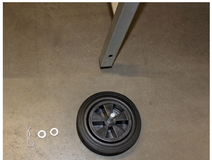
Demontierte Rolle am Standfuß
