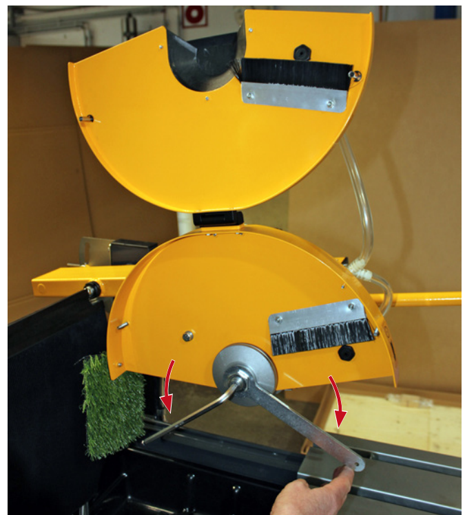
Schutzdeckel nach oben aufklappen und Schneidwellenmutter lösen
