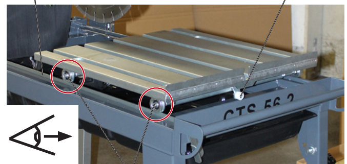
Rolltisch mit den Führungsrollen (links am Tisch) auf die Führungsschiene setzen Bild 4.11
