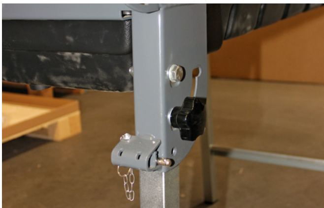
Rollen-Halter am Tischsägerahmen
