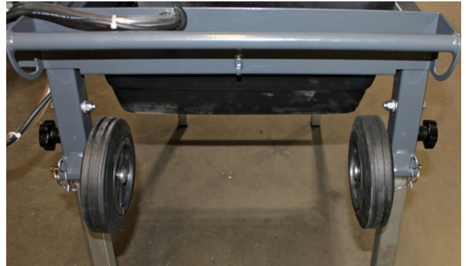
Rollen oben am Tischsäge-Rahmen montiert
