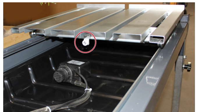
Rolltisch-Anstoßdämpfer hinten, Wasserpumpe in Wasserwanne Bild 4.12
