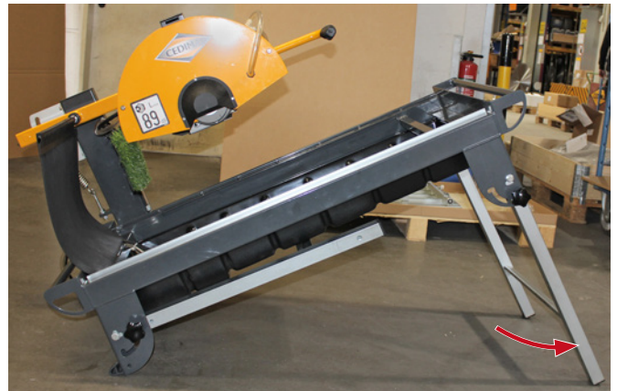
Standfuß-Paar abschnwenken (Tischsäge aufstellen)
