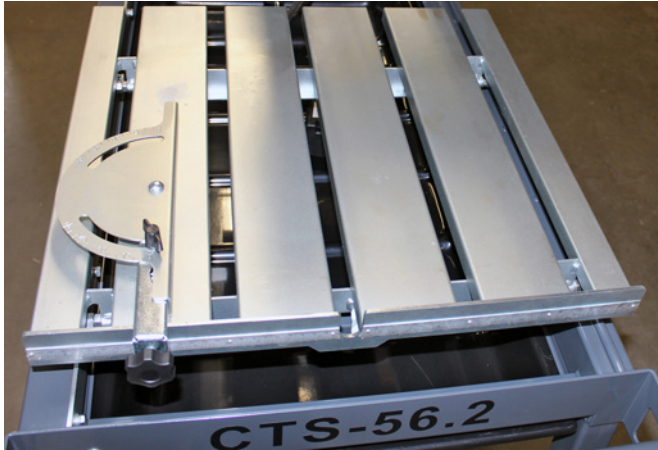
Winkelanschlag auf den Werkstückanschlag des Rolltisches geklemmt Bild 4.13
