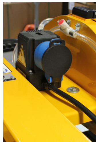
Netz-Anschluss-Stecker an der CTS-56.2
