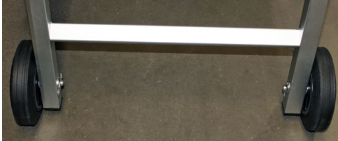
Rollen an den Standfüßen außen montiert
