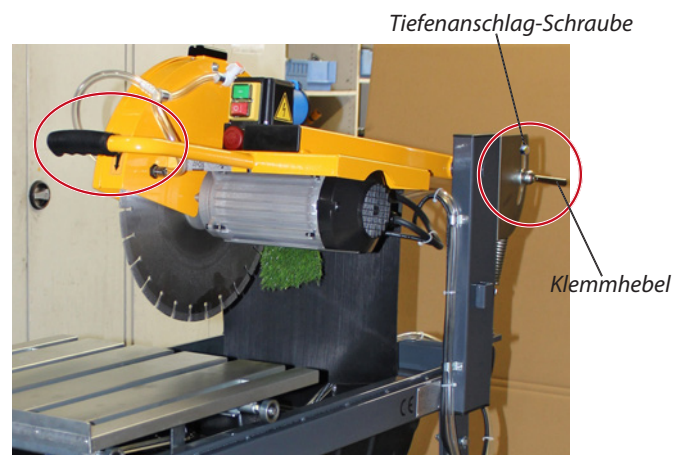
Klemmhebel lösen und den Pendelschneidarm festhalten Bild 4.23
