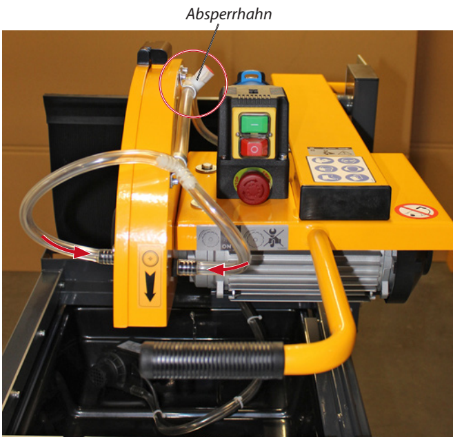
Beidseitiger Wasserzulauf am Trennscheibenschutz, stufenlos mit Absperrhahn regulierbar
